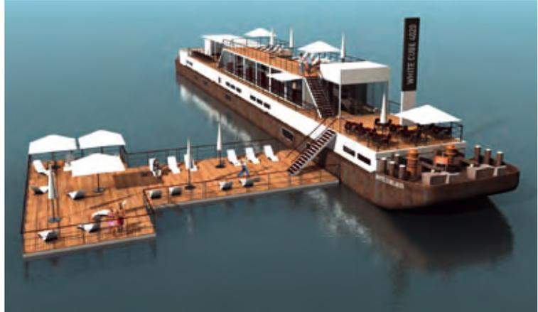
Das *White Cube 4020* ist ein modulares Gastronomie- und Eventschiff. Die Ausgangsbasis ist ein alter Schubleichter, dessen enormer Laderaum Platz für ein Bestandskonzept im Unterdeck, jedoch auch Stauraum für ein modulares Containerraumsystem bietet, das eigenständig mittels eines Brückenkrans ein- und ausladbar sowie auf- und abbaubar ist.
